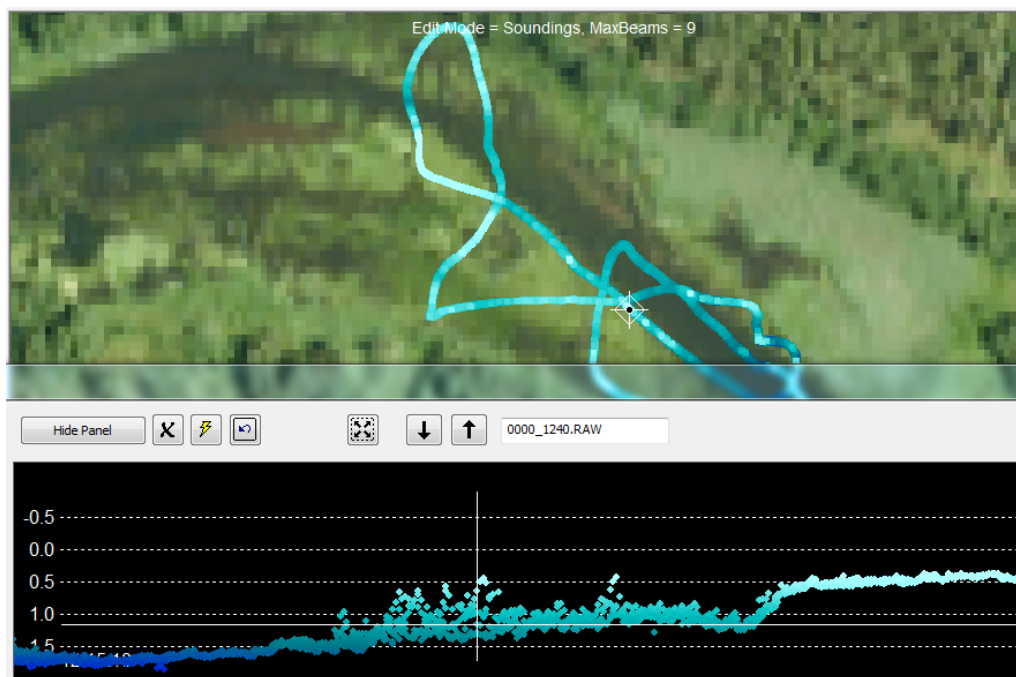
Figur 3 Eksempel hvor sejlruen passerer et område med grøde. Det hvide trådkors på kortet er samme position som vist i dybdeprofilen nederst.
