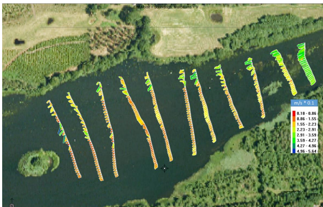
Figur 20 Hastigheder midlet for dybden er vist med henholdsvis vektorretning og størrelse. Farverne angiver intervallerne. Rød til orange er 0 til ca. 20 cm/s, Lysegrøn og grøn er hastigheder på 20 til 40 cm/s. Højere værdier er enkelt målinger som kan være støj.
