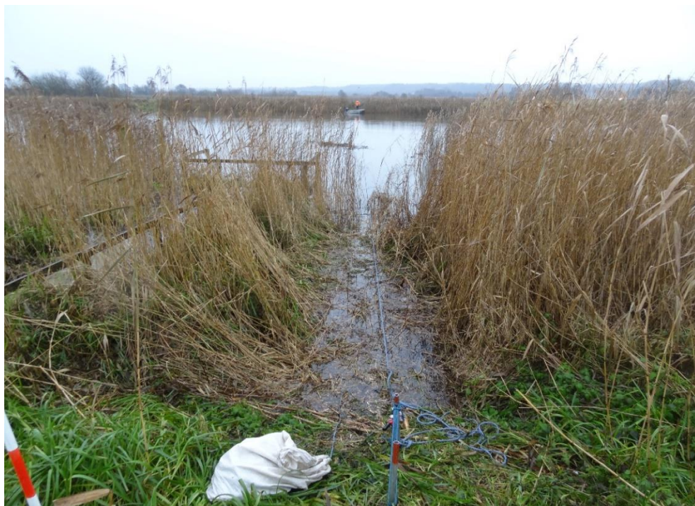
Foto 2. Metode for opmåling af tværsnit i Gudenåen i december 2016. Opmålingen er foretaget fra båd langs et tov, udspændt vinkelret på tværs af vandløbet.
